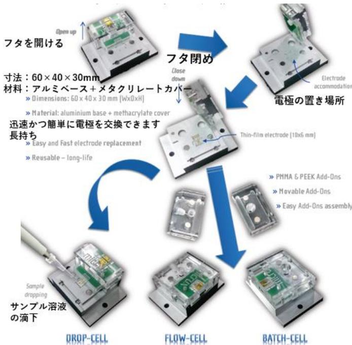
オールインワンセルは、ベースセル(コード: ED-AIO-CELL)+ 拡張機能オプションモジュール1 個 (コード: ED-AIO-CELL-1x) またはベースセル(製品コード: ED-AIO-CELL) + アドオン (製品コード: ED-AIO-CELL-2x) の2つの基本バージョンで提供されます。追加のアドオンは、ベースセルと一緒に、または別々に提供でき、顧客の特定の要件を考慮してカスタマイズ(設計と材料) できます。
