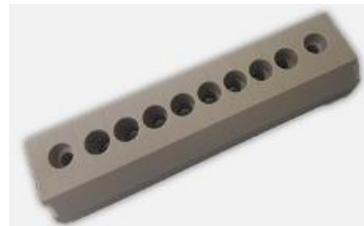
材質: PEEK、有機溶媒対応。より大きなサンプル量 (セルあたり最大 400 µL) に対応。最大 8 つの標準薄膜 (マイクロ) 電極を使用できます。バッチセルアドオン機能は、96 ウェルマイクロプレートの列 (A-H) に対応しています。SE1、IDA、IDRA、IDE、mSE 薄膜電極と互換性があります。電気化学セル: 最大 5 mm Ø、サンプル容量: 最大 400 µL、ネジによるアドオン組み立て。ED-SE1、ED-mSE1、ED-IDA1、ED-IDA5、ED-IDA6、ED-IDE1、ED-IDE2、ED-IDE3、ED-IDRA1 と互換性があります。
