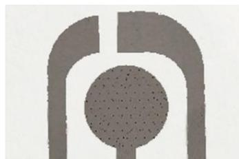
薄膜 MEA 電極は、短時間で定常状態に到達することで分析信号を強化する典型的なマイクロ電極の動作を示します。
