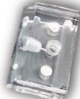
コード **ED-AIO-ADD-ON-FC-PMMA-2.0** 材質: PMMA、電気化学セル: 2 mm Ø。アドオンは磁石によって **ED-AIO-CELL** ベースセル (**ED-AIO-CELL**) に取り付けられます。MicroX ED-SE1, ED-mSE1, ED-IDA1, ED-IDA5, ED-IDA6, ED-IDRA1 電極に対応。
