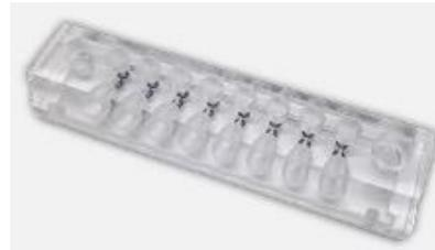
**コード Ref. ED-ADD-ON-8x-FC-PMMA-2.0:** FIA、HPLC、CE などのシステムでの検出に最適なウォールジェットフローセル。デッドボリュームとサンプル要件が低い。SE1、IDA、IDRA、mSE 薄膜電極と互換性があります。材質: PMMA 樹脂、電気化学セル: 2 mm Ø、ネジによるアドオン組み立て。ED-SE1、ED-mSE1、ED-IDA1、ED-IDA5、ED-IDA6、ED-IDRA1 と互換性があります。
