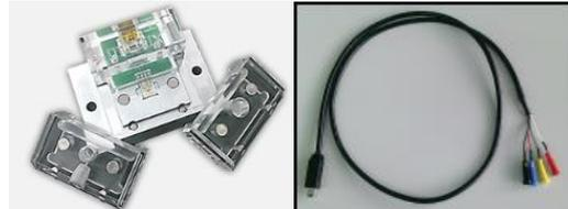
静的または動的実験条件用のアドオンが1つ付いたAIO ドロップセルベース。フロー、バッチ、または薄層アドオンと互換性があります。セルはEEPプラットフォームとも互換性があります。
