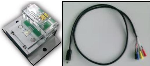
ユーザーフレンドリーなインターフェイスです。すべての薄膜電気化学センサーで微量(1~10 μL のサンプルの滴) の使用を可能にします。ドロップセルには、さまざまなアドオンモジュールと組み合わせ可能。
